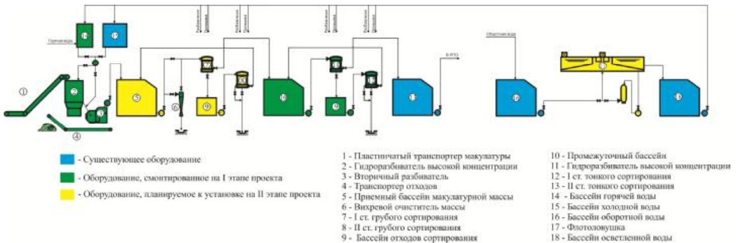
Рисунок 2.6. Технологическая схема подготовки макулатурной массы
